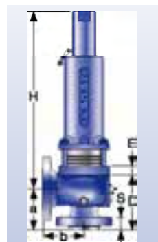
Diseño con fuelle balanceado
